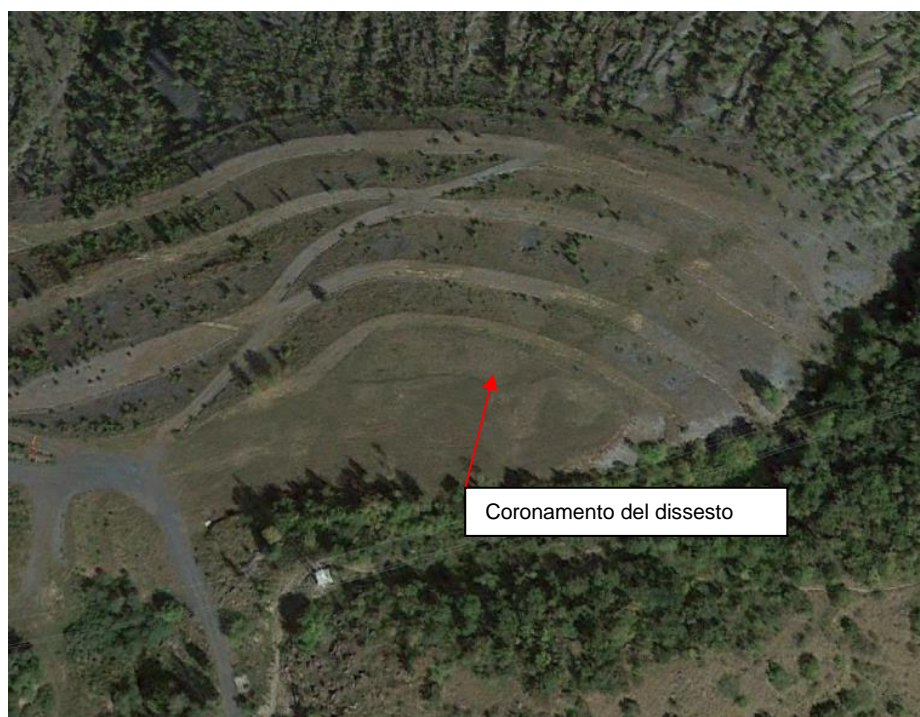
Figura 28 – Ubicazione su foto aerea del sito d'intervento con indicazione della linea di frattura evidenziatasi nell'ambito dei depositi detritici
