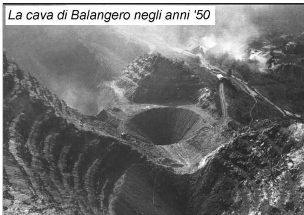
Figura 1 – Schema lavorazione a “glory hole”
